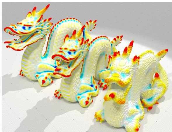
Stabilité et convergence de quantités géométriques différentielles (ici la courbure moyenne) sur des surfaces de voxels et des maillages triangulées.
